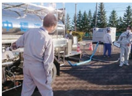
加圧式給水車により給水コンテナに送水
