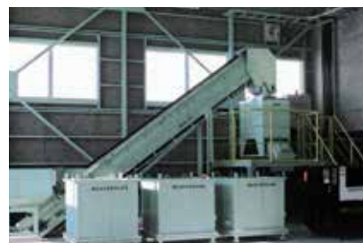
↑ガラスびん選別破碎設備 せんべつはさいせつび トレー・発泡スチロール減容設備
