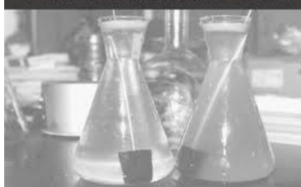
ワイルドマンフラスコによるダニ浮遊法
